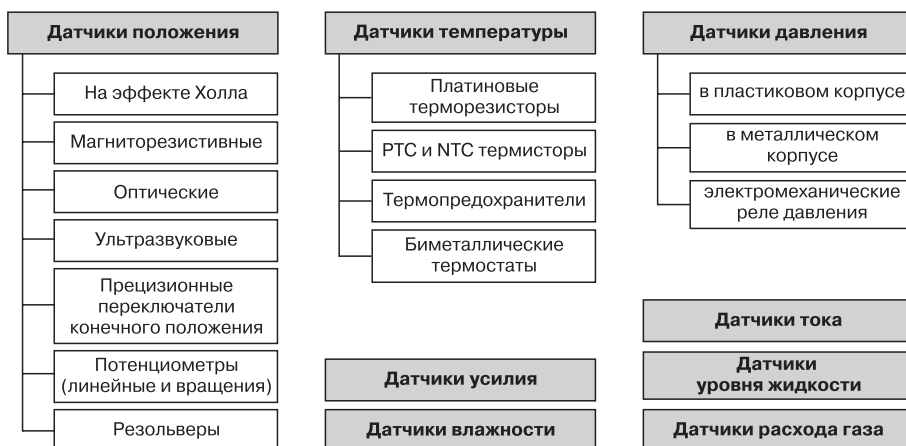
Рис. 1. Классификация датчиков, выпускаемых Honeywell в настоящее время
