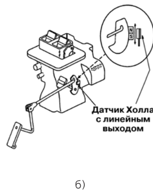
Рис. 5. Примеры использования датчиков магнитного поля с линейным выходом: а) измерение давления (усилия); б) контроль положения дроссельной заслонки; в) датчик тока с гальванической развязкой
