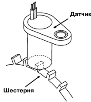
Рис. 13. Принцип действия датчиков скорости вращения
